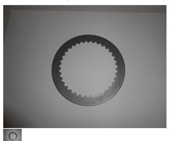
Stahl Zwischenlamelle 1,5 mm für alle Maico MC, GS, SM Modelle ab Baujahr 1983 bis heute. Benötigt werden 6 Stück im Paket mix mit zwei Sinter und 5 Organischen Belägen. Bei einer kpl. organischen Kupplung werden 5 Stück benötig. Bei einer 6 Federn Vollsinterkupplung werden 7 Stück benötigt!
